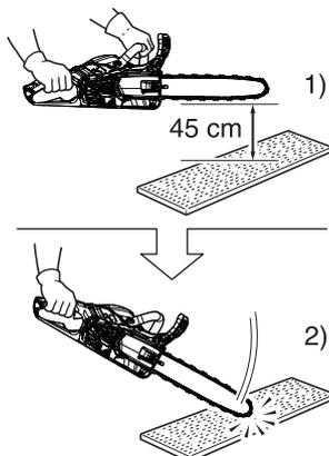
Le frein de chaîne stoppe la chaîne de telle sorte que le phénomène de rebond provoqué à l'extrémité du guide-chaîne active automatiquement le frein de chaîne.
