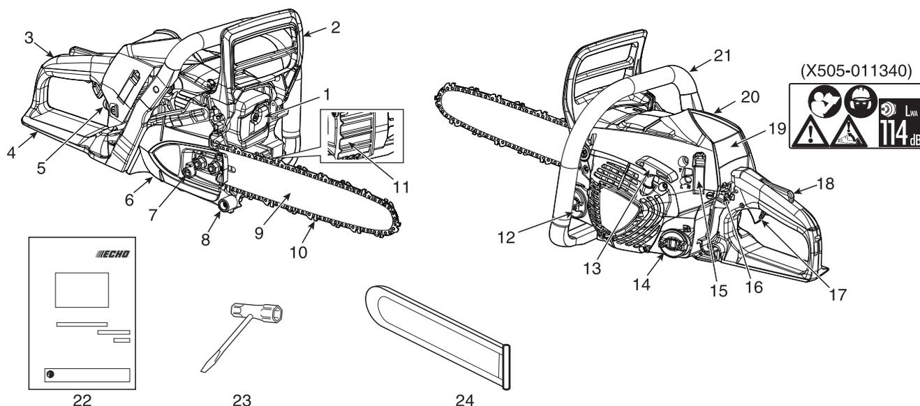
1. **Silencieux** - le silencieux réduit le bruit de l'échappement et évite la projection de particules de carbone incandescentes hors du silencieux.
