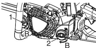
1. Bouchon du réservoir d'huile
