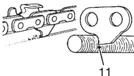
11. Le maillon d'entraînement permet de retirer la sciure de la rainure du guide-chaîne.
