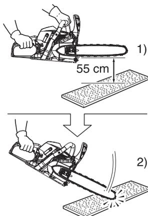
Le frein de chaîne stoppe la chaîne de telle sorte que le phénomène de rebond provoqué à l'extrémité du guide-chaîne active automatiquement le frein de chaîne.
