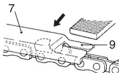
7. Le limiteur détermine l'épaisseur du copeau, et il faut l'entretenir soigneusement pendant toute la durée de vie de la chaîne.
