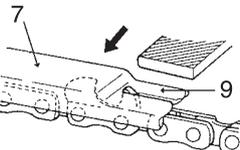
7. Le limiteur détermine l'épaisseur du copeau, et il faut l'entretenir soigneusement pendant toute la durée de vie de la chaîne.
