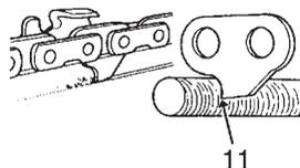
11. Le maillon d'entraînement permet de retirer la sciure de la rainure du guide-chaîne.
