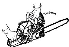
1. Poser la tronçonneuse sur le sol.
