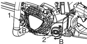
1. Bouchon du réservoir d'huile
