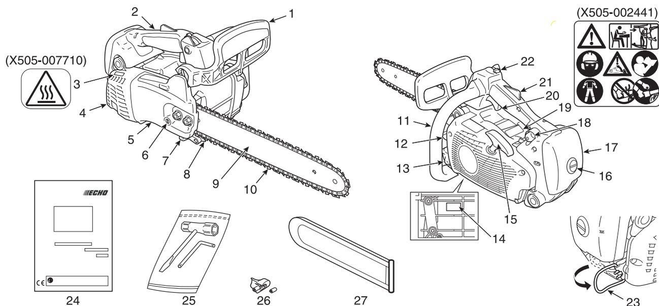
1. **Protège-main avant** - Protection placée entre la poignée avant et la chaîne pour protéger la main contre les blessures et conserver la maîtrise de la tronçonneuse si la main glisse de la poignée. Cette protection sert également à activer le frein de chaîne qui arrête la rotation de la chaîne.
