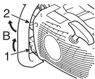
1. Bouchon du réservoir d'huile
