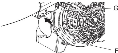
1. Insérer le tournevis (F) dans l'orifice situé près du symbole de blocage (G) pour débloquer le tuyau.
