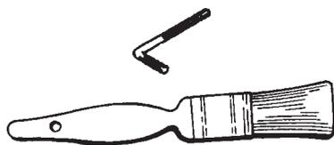
Outils nécessaires : Clé coudée Torx T27, pinceau de nettoyage
