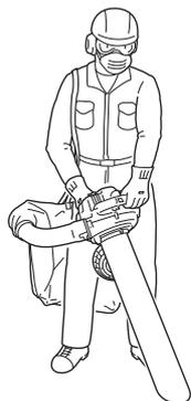
1. Régler la sangle du sac à débris afin de pouvoir le porter sur l'épaule. Le sac ne doit présenter aucun pli au niveau de l'orifice d'admission, afin d'éviter tout risque d'obstruction. Il peut être nécessaire de régler à nouveau la sangle à mesure que le sac se remplit et s'alourdit.
