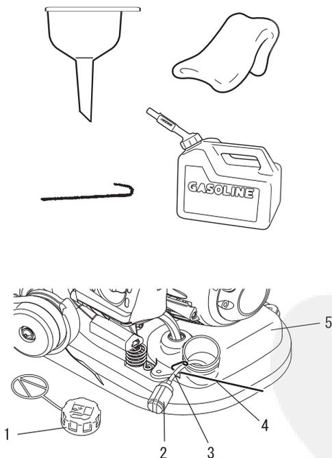
1. Bouchon du réservoir de carburant
