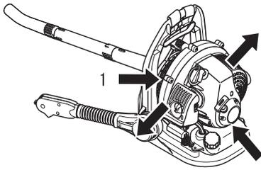
1. Eliminer les débris accumulés sur la grille d'admission entre le cadre de portage et le corps du souffleur.
