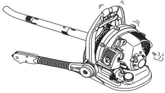
1. Lorsque le moteur démarre, le laisser chauffer au ralenti (c.-à-d. à bas régime) pendant 2 à 3 minutes.
