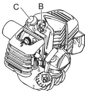
8. Retirer la bougie d'allumage (B) et ajouter la quantité d'huile appropriée (environ 10 ml) d'huile propre pour moteur à 2 temps dans le cylindre via la douille d'installation.
