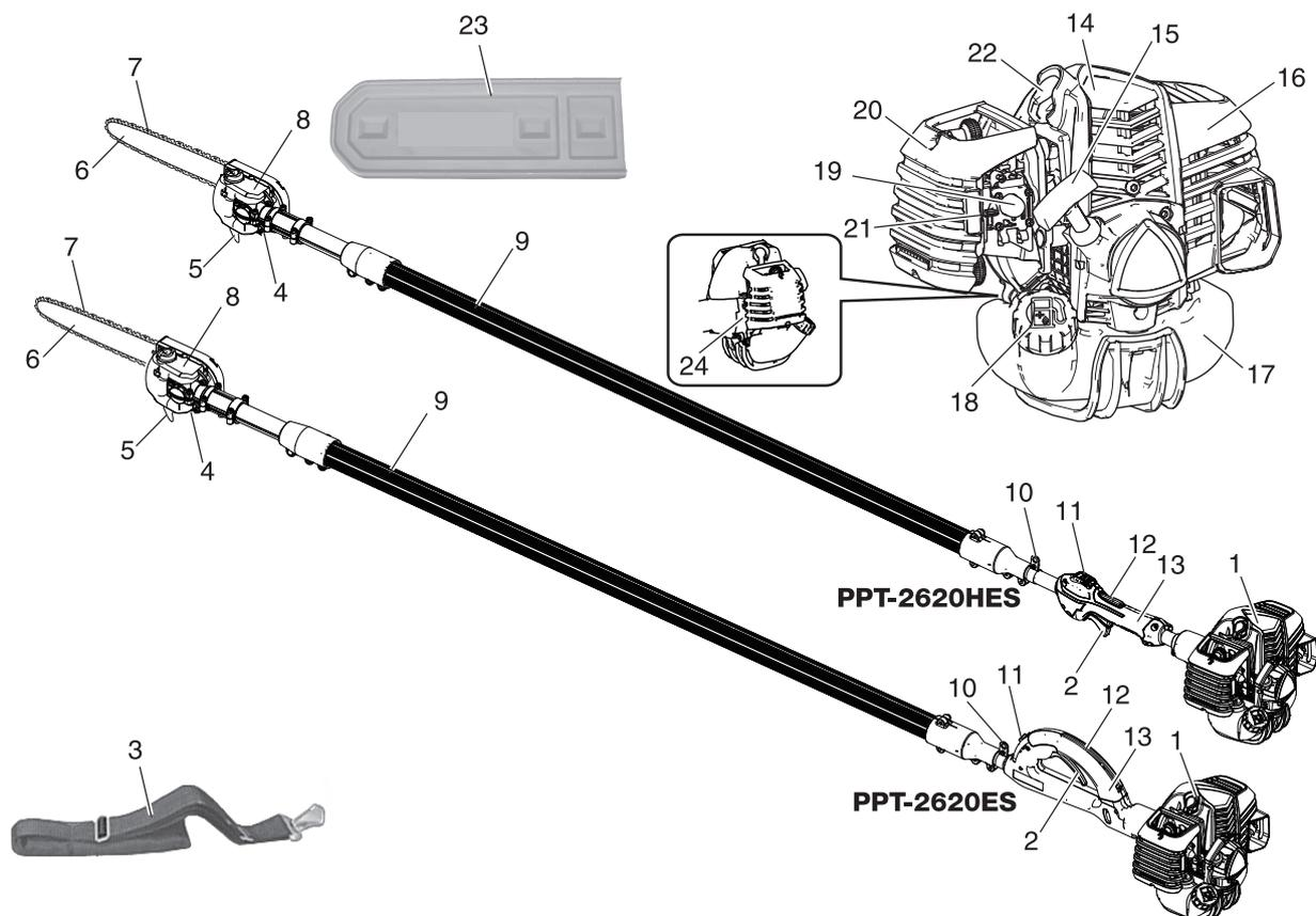
1. **Tête du souffleur** - Comprend le moteur, l'embrayage, le système de carburant, le système d'allumage et le démarreur.
