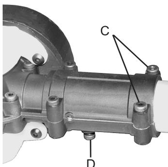
1. Desserrer les deux vis (C) et la vis de fixation (D) sur l'outil de coupe.
