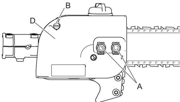
1. Retirer deux écrous (A) et la vis du protecteur de guide-chaîne (B).
