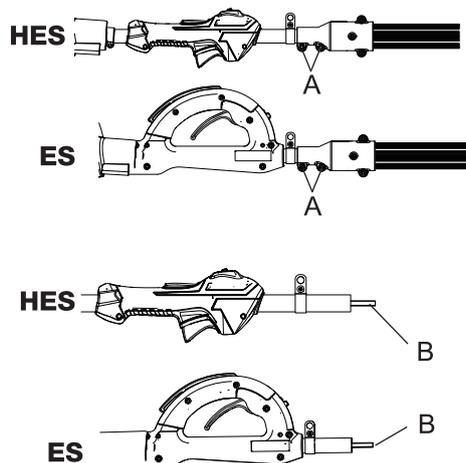
1. Desserrer les vis de serrage (A) sur l'accouplement d'arbre d'entraînement.
