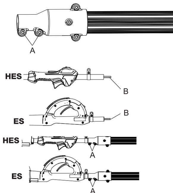
1. Retirer les bouchons de protection de l'ensemble d'arbre de poignée.
