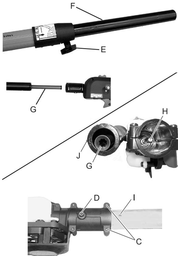
2. Dévisser le bouton de serrage (E) en le tournant dans le sens contraire des aiguilles d'une montre.
