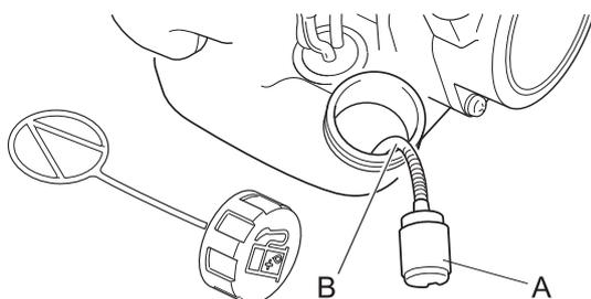
1. Utiliser un fil métallique ou équivalent pour faire sortir le filtre à carburant (A) par l'orifice du réservoir de carburant.
