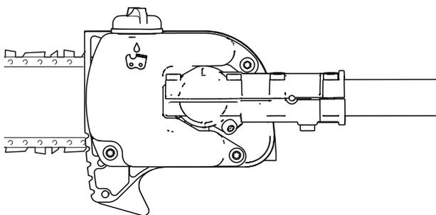
1. Essuyer les débris entourant le bouchon de remplissage d'huile.
