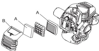
1. Couper le starter. Dévisser le bouton du couvercle de filtre à air et déposer le couvercle du filtre à air (B).
