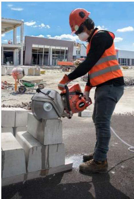
Disqueuse avec système de filtration en 4 étapes.
